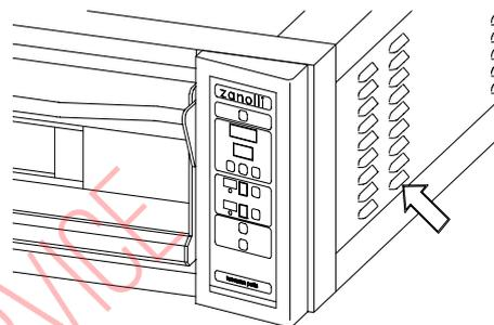
Fig. 5.1 Aperture per il raffreddamento
